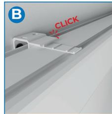
Drücken Sie den Clip, bis er spürbar in der Halterung einrastet. Für eine evtl. Demontage kann der Clip seitlich rausgeschoben werden..
