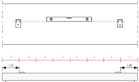
Um die ideale Montageposition für die Halterungen zu ermitteln teilen Sie die Gehäusebreite in 8 Teile. Die Halterungen sollte ca. ein 1/8 der Gehäusebreite Ihrer Bildwand von den Stirnseiten jeweils eingerückt montiert werden. Die Halterungen eignen sich sowohl für die Montage an der Wand oder auch an der Decke. Bringen Sie die Halterungen auf einer Linie an und bohren Sie die Montagelöcher.
