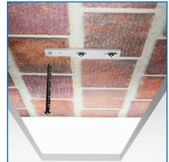
Die endgültige Befestigung der Ankerplatte an der Rohdecke sollte mit Dübeln erfolgen, die für die Art des Untergrunds geeignet sind.
